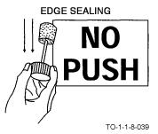
Figure 7-11. Edge Sealing
