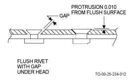
Figure 4-9. Rivet Head Criteria
