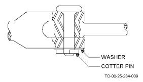
Figure 4-6. Clevis Pin
