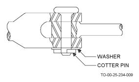
Figure 4-6. Clevis Pin
